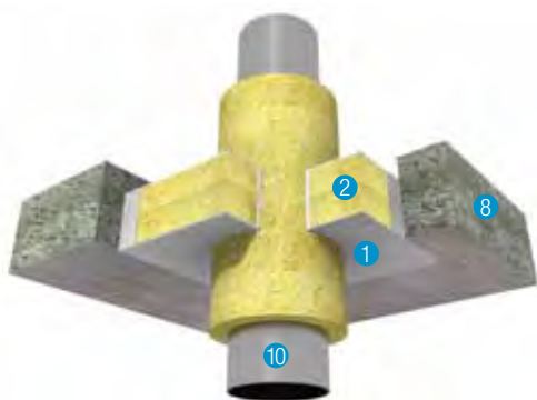
Detalle G - Sello de penetración de tubería de metal en suelo rígido
